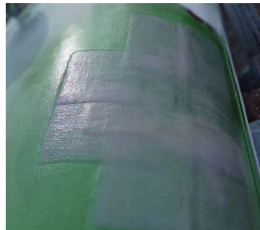
Nach der fachmännischen Reparatur ist das Güllefass wieder dicht und die Schadstelle fällt kaum noch auf.
