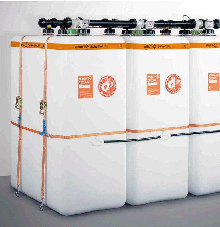
Damit die Heizöllagerung auch in hochwassergefährdeten Gebieten eine sichere Sache bleibt, bietet WERIT ein System zur Auftriebssicherung an. Zum Einsatz kommen wanddickenverstärkte Sicherheitstanks in Verbindung mit einem Bodenverankerungssystem als Auftriebssicherung. Die Auftriebssicherung ist in zwei verschiedenen Ausführungen für Überflutungshöhen von 1,40m und 3,50m erhältlich.
